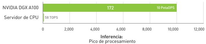
Servidor de CPU: 2 Intel Platinum 8280 con INT8 | DGX A100: DGX A100 con 8 A100 con INT8 y baja densidad estructural
