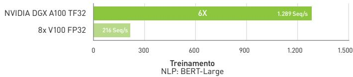
Taxa de transferência de pré-treinamento BERT usando o PyTorch, incluindo (2/3)Fase 1 e (1/3)Fase 2 | Fase 1 Seq Len = 128, Fase 2 Seq Len = 512 | V100: DGX-1 com 8 V100 usando precisão FP32 | DGX A100: DGX A100 com 8 A100 usando precisão TF32
