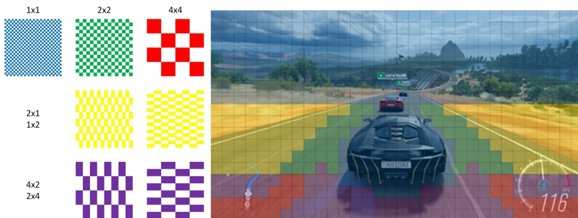
图 32. Turing VRS 支持的着色速率和对游戏帧的应用示例
