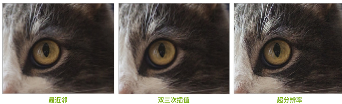
图 26. AI Super Rez 相比其他过滤方法提供更高的图像清晰度
