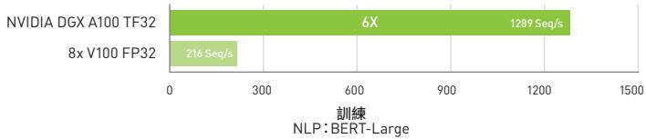
以 PyTorch 執行 BERT 預先訓練傳輸量，包括 (2/3) 階段 1 和 (1/3) 階段 2 | 階段 1 區段長度 = 128，階段 2 區段長度 = 512 | V100:DGX-1 搭配 8x V100，使用 FP32 精度 | DGX A100:DGX A100 搭配 8x A100，使用 TF32 精度
