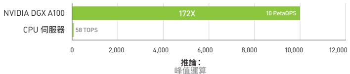
CPU 伺服器：2x Intel Platinum 8280，使用 INT8 | DGX A100:DGX A100 搭配 8x A100，使用 INT8，結構稀疏
